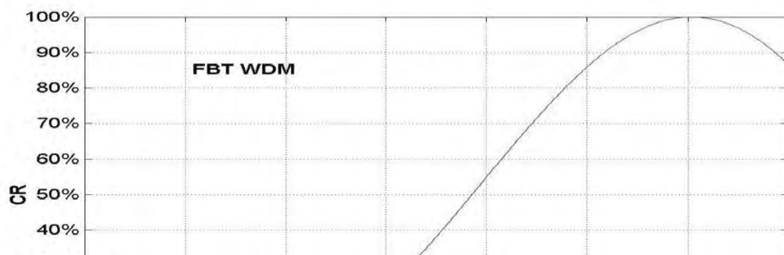
图 62. 1310nm/1550nm 双窗宽带 3dB 耦合器的波长相关性
