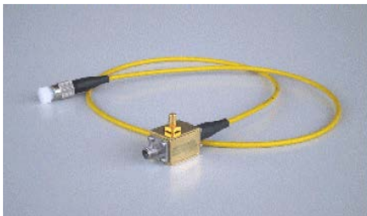
UltraFast 20/35 SM 探测器标准结构
